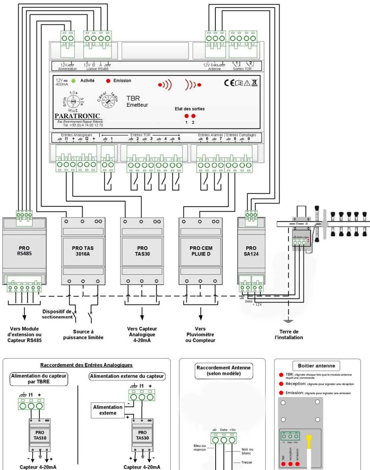
Attention, l'alimentation du TBRE doit être protégée (limitée) par un fusible 1A ou tout système équivalent assurant la protection.
