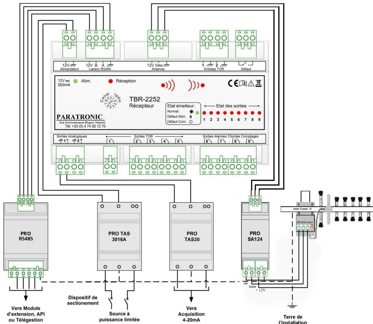
Attention, l'alimentation du TBR Récepteur doit être protégée (limitée) par un fusible 1A ou tout système équivalent assurant la protection.
