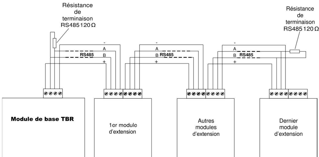
Les modules d'extension permettent d'étendre le nombre de voies des TBR émetteur ou récepteur (analogiques, comptages, entrées et sorties tor, PT100, radar Cruzoé RS485), via le port RS485.
