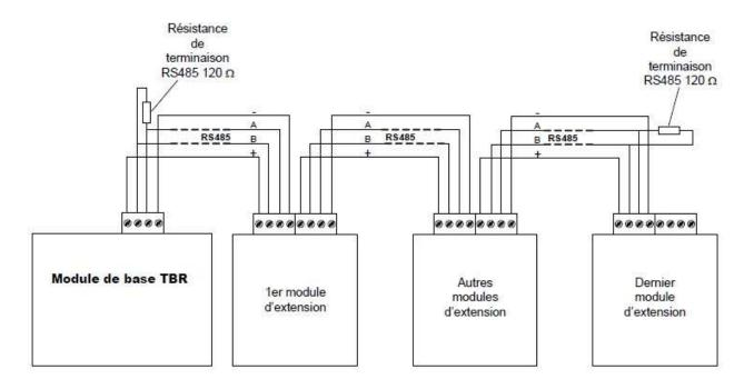
Les modules d'extension permettent d'étendre le nombre de voies des TBR émetteur ou récepteur (analogiques, comptages, entrées et sorties tor, PT100, radar Cruzoé RS485), via le port RS485.
