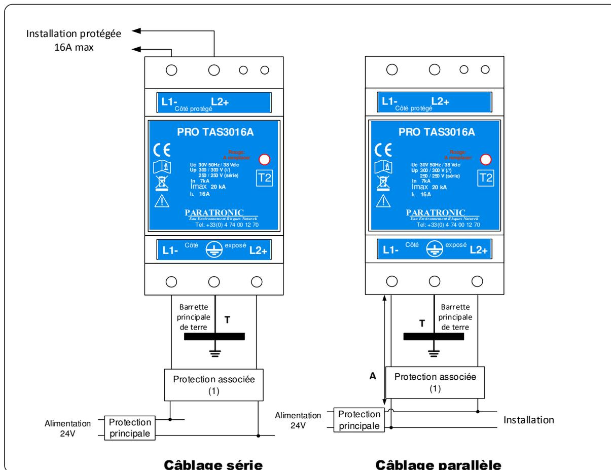
(1) Protection externe du parafoudre contre les surintensités : Disjoncteur bipolaire 16A courbe C
