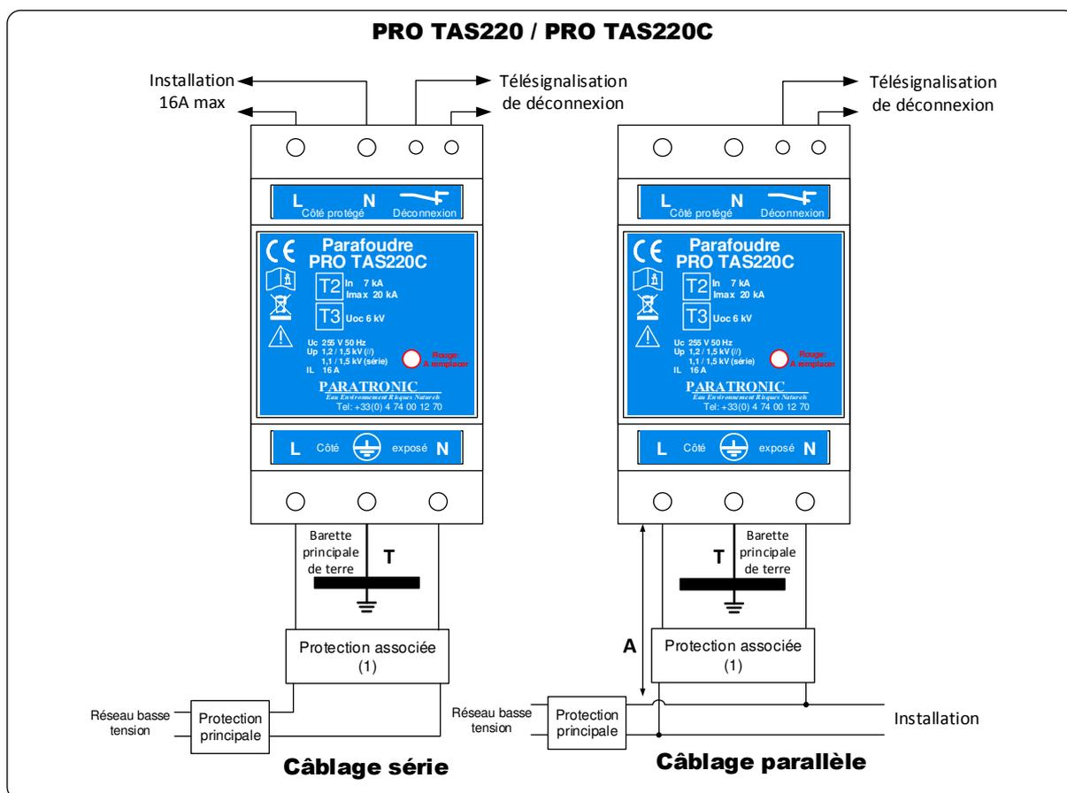
(1) Protection externe du parafoudre contre les surintensités : Disjoncteur bipolaire 16A courbe C
