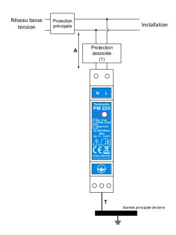
(1) Protection externe du parafoudre contre les surintensités : Disjoncteur bipolaire 10A courbe C.
