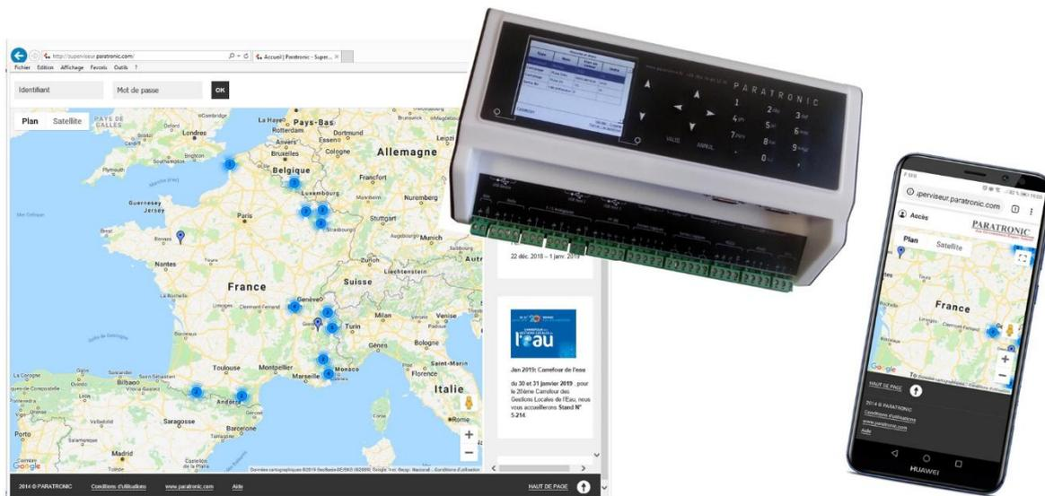
Basée sur une station d'acquisition ultra faible consommation et un superviseur web (logiciel hébergé), la solution PARATRONIC, vous permet de réaliser les mesures de niveau, pluviométrie, débit, qualité des eaux (température, pH, ...).
