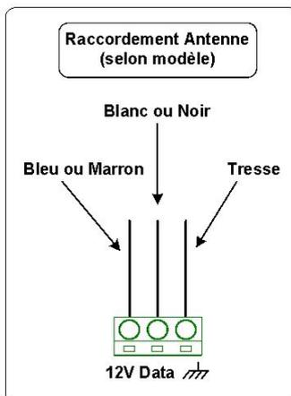
Attention, l'alimentation du TBRE doit être protégée (limitée) par un fusible 1A ou tout système équivalent assurant la protection.
