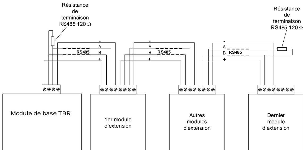
Les modules d'extension permettent d'étendre le nombre de voie des TBR émetteur ou récepteur (analogiques, comptages, entrées et sorties tor, PT100, radar Cruzoé RS485), via le port RS485. Ils se raccordent sur le port RS485 du TBR (préalablement paramétré en JBUS/MODBUS maître). Ils sont généralement montés en cascade, avec report de l'alimentation (voir plan ci-dessus). Câbler 2 résistances de terminaison de 120Ω si les modules sont situés à plus de 10m du module de base.
