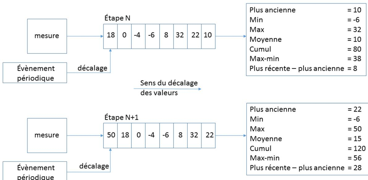
Le contenu de la liste glissante s'affiche en dessous du paramétrage pour faciliter la mise au point d'un automatisme.
