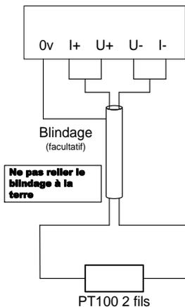
La résistance des fils doit être compensée (voir la section paramétrage). Si cette valeur n'est pas connue, procéder par étalonnage.
