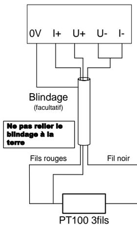
La compensation de résistance des fils est automatique si les 3 fils sont de même résistance.
