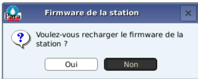
Cet écran permet de charger le Firmware de la station LNS à partir d'une clef USB. Le Firmware ne doit pas être « zippé » et doit se trouver à la racine de la clé (= pas dans un dossier).
