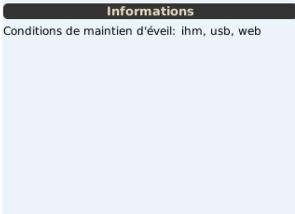
Affiche les conditions de maintien d'éveil de la station. Utilisé lors de la maintenance pour comprendre la cause du non passage en veille d'une station.
