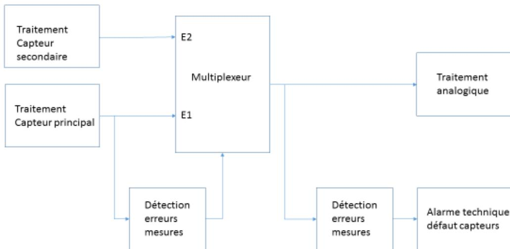
6) Changement de capteur en fonction de la valeur d'une mesure.
