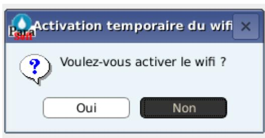
Cet écran permet d'activer l'alimentation du port **USB Host n°1**. La clé wifi sera automatiquement activée sous réserve que son paramétrage le permette.
