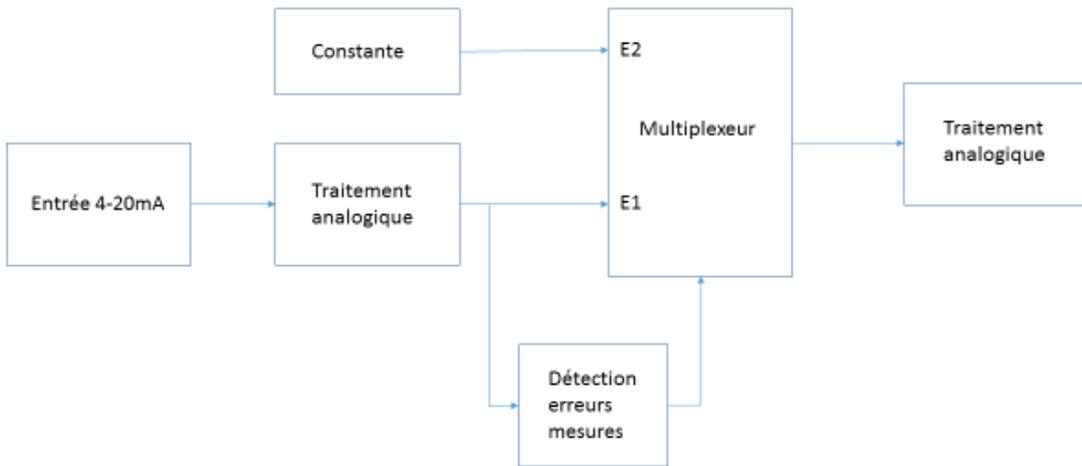
5) Utilisation d'un capteur de secours en cas de panne capteur:
