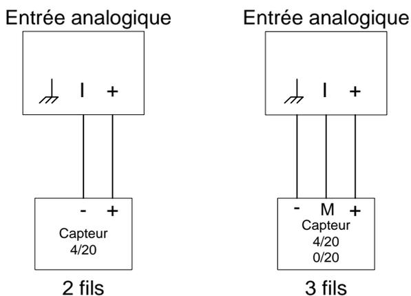
Raccordement d'un capteur analogique 4-20mA (ou 0-20mA), alimentation externe:
