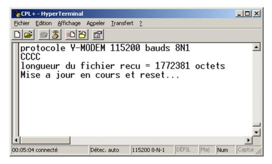
IMPERATIF : Ne pas mettre CPL+ « hors tension » avant la fin du téléchargement de la mise à jour et le redémarrage de la centrale.
