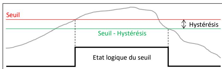
Dans le cas d'un dépassement vers le bas, le gradient est activé lorsque la valeur de l'entrée est inférieure ou égale au seuil. Le gradient est ensuite désactivé lorsque cette valeur devient supérieure à (Seuil + Hystérésis)
