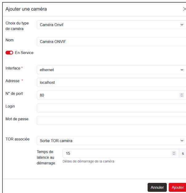
Nota : la plupart des caméras ONVIF refusent de fonctionner si leur heure n'est pas synchronisée avec celle de la station, pour des raisons de sécurité. Pour assurer le fonctionnement de ces caméras, renseigner l'adresse de la station comme serveur NTP sur les interfaces propriétaires des caméras concernées (la station faisant office de serveur NTP).
