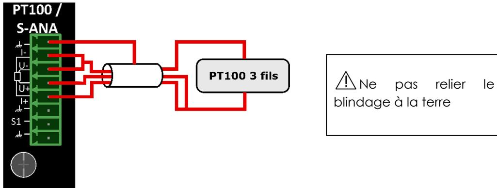
La compensation de résistance des fils est automatique si les 3 fils sont de même résistance.
