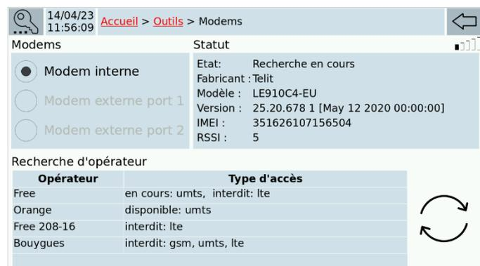
La touche située en bas à droite de l'écran permet de lancer une recherche d'opérateurs (même si aucune carte SIM n'est insérée dans le modem) afin de déterminer quels sont les opérateurs accessibles et leurs types d'accès.
