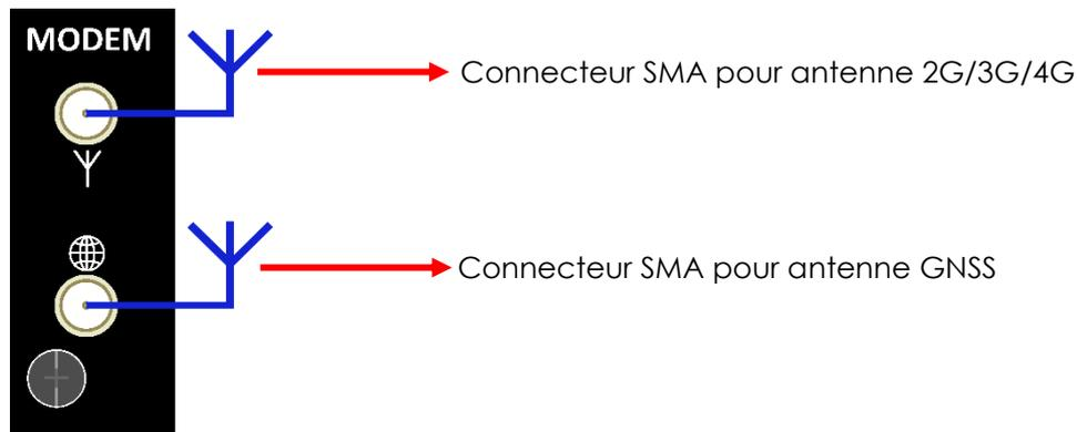
**Attention :** pour respecter les limites d'exposition aux ondes électromagnétiques, une distance minimum de 20cm doit être maintenue entre le personnel et l'antenne 2G/3G/4G.
