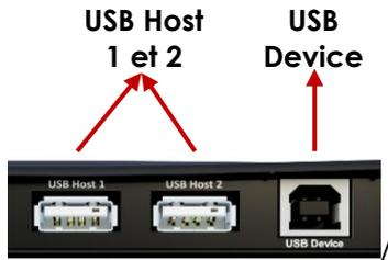
Le port USB DEVICE (embase carrée) est destiné à connecter un terminal local pour le paramétrage de la station (IHM). Utiliser un cordon assemblé de type A-B.
