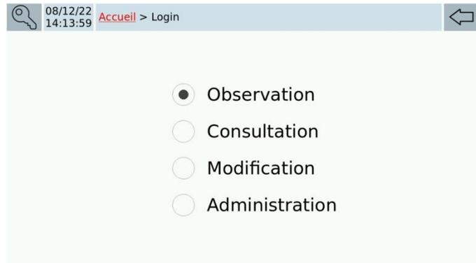
Les niveaux d'autorisation nécessitant des mots de passe ouvrent un clavier sur lequel il convient de renseigner le mot de passe correspondant au niveau sélectionné. En cas d'absence de mot de passe dans la configuration des accès, appuyer directement sur la touche « Entrée ».
