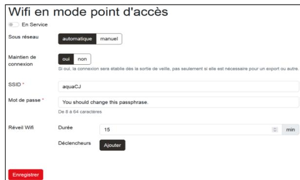
Si vous êtes déjà connecté à la station, vous pouvez modifier les paramètres du point d'accès Wifi dans la page « Communication », dans l'onglet « Wifi en mode point d'accès »
