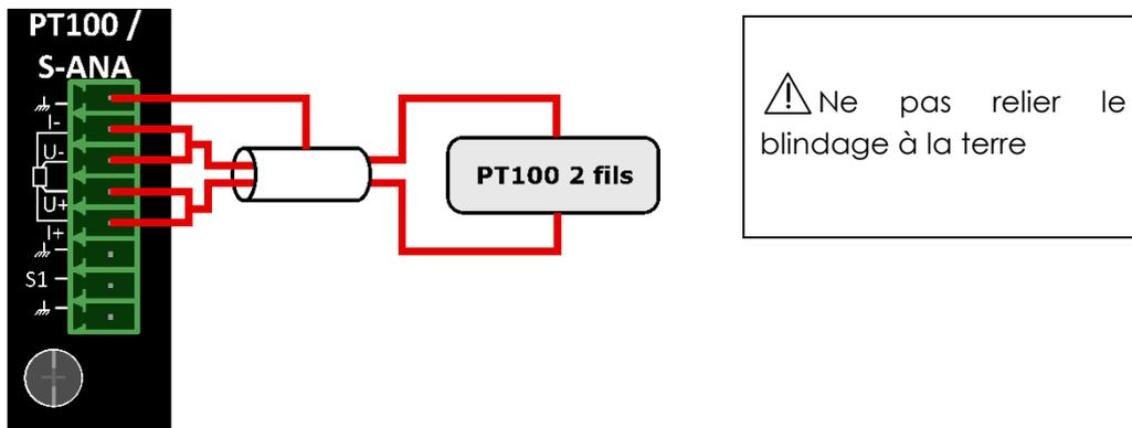
La résistance des fils doit être compensée (voir la section paramétrage). Si cette valeur n'est pas connue, procéder par étalonnage.
