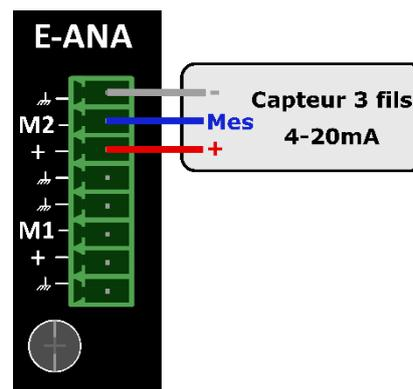
**6.2.1.3.2 Raccordement d'un capteur analogique 4-20mA avec une alimentation externe**
