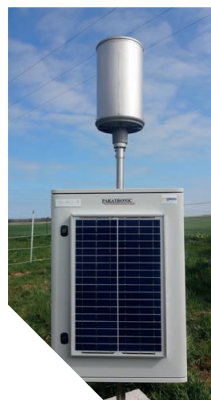
Capteur pluvio + panneau solaire
